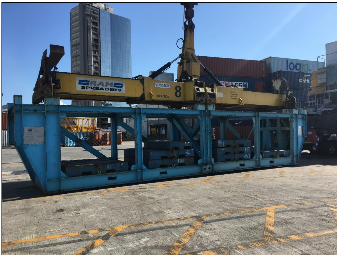
Figura 5. Teste de carga – Twin Lift.
